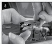
Sostituire con una nuova puntina, assicurarsi che i cavi audio siano montati saldamente e quindi agganciarli nuovamente al braccio del giradischi.
