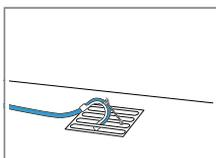
Spostare completamente il tubo flessibile di scarico dell'acqua attraverso il collettore e fissare con il materiale apposto. Fissare il collettore al pozzetto.
