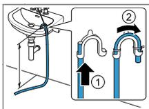
Spostare completamente il tubo flessibile di scarico dell'acqua attraverso il collettore e fissare con il materiale apposto. Fissare il collettore a un'altezza massima di 100 cm.
