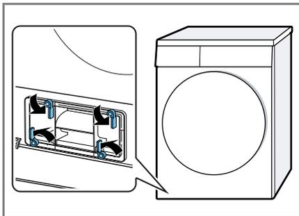
3. Estrarre la copertura dello scambiatore di calore sulla maniglia.
