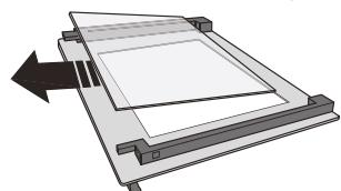
3. Vuelva a colocar la hoja intermedia (marcada con "1R") antes de montar la hoja interna: Para colocar las hojas de cristal correctamente, asegúrese de que la marca «R» se vea en la esquina de la izquierda. Primero introduzca el lado largo del cristal marcado con una "R" en los soportes y después bájelo hasta su posición. Repita este procedimiento en ambas hojas de cristal.
