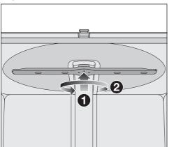
■ Premere il braccio irroratore superiore verso l'alto ① in modo che la dentatura si incastri e svitarlo in senso antiorario ② (vista dal basso).
