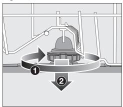
Ruotare il raccordo del braccio irroratore centrale in senso orario (vista dall'alto) e toglierlo (2).
