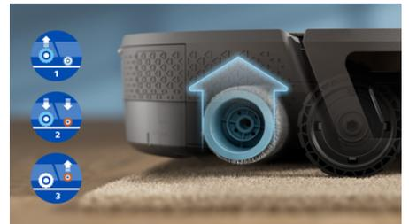
Philips HomeRun serie 9000 si adatta perfettamente ai diversi tipi di pavimento. Grazie al sistema di sollevamento a doppio rullo, il panno si solleva automaticamente per evitare di bagnare i tappeti.
