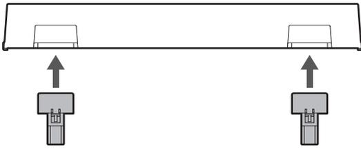
**2** Inserire le cerniere della copertura antipolvere sui relativi supporti sul retro del corpo.
