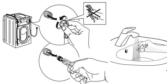
4. Inserire nuovamente il filtro a rete. Collegare nuovamente il tubo di carico al rubinetto dell'acqua e alla lavatrice. Non utilizzare un utensile per collegare il tubo di carico. Aprire il rubinetto dell'acqua e controllare che tutti i collegamenti siano ben serrati.
