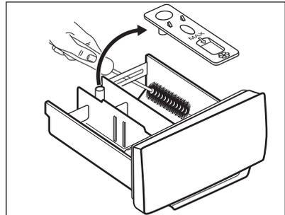
3. Verificare che tutti i residui di detersivo vengano rimossi dalla parte superiore e inferiore dell'incasso. Servirsi di una spazzola piccola per pulire l'incasso.
