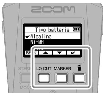
Impostate correttamente il tipo di batteria in uso, in modo che la carica residua sia visualizzata con precisione.
