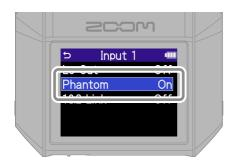
Abilitate l'alimentazione phantom per gli ingressi che hanno un microfono a condensatore collegato.
