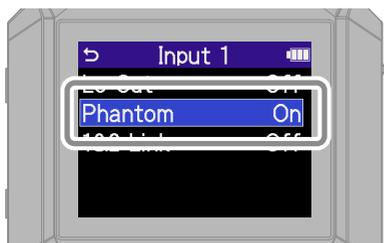
Abilitate l'alimentazione phantom per gli ingressi che hanno un microfono a condensatore collegato.
