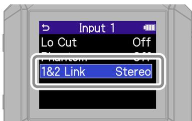
In stereo-link, le tracce sono registrate come file stereo con la traccia 1 su L e la traccia 2 su R.
