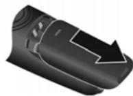
Se fosse necessario aprire il coperchio delle batterie, ad es. per cambiarle, sfruttare la piccola scanalatura sopra il coperchio per spingerlo verso il basso e sollevarlo.
