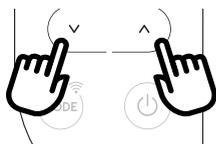
È possibile visualizzare la temperatura in °C o °F. Per cambiare l'unità di misura della temperatura, tenere premuti o premere separatamente i tasti di aumento ^ (C4) e diminuzione v (C3) per circa 10 secondi.
