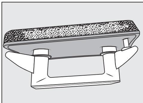
I residui sono dovuti alle fibre del bucato e al detersivo, e intasano il filtro. I residui si fermano sulla parte anteriore e ai lati del filtro. In casi estremi tali residui formano incrostazioni ostinate.
