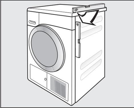
Posizionare l'asciugatrice in bolla affinché funzioni correttamente. Compensare le irregolarità del pavimento utilizzando i piedini.
