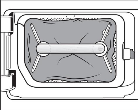
I bordi del filtro zoccolo non aderiscono e il filtro zoccolo è deformato. Per questo motivo la lanugine passa dai bordi che non aderiscono e raggiunge lo scambiatore di calore. A lungo andare lo scambiatore di calore si blocca.
