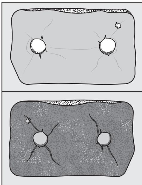
La lanugine passa attraverso le crepe e gli strappi, viene aspirata nello scambiatore di calore. A lungo andare lo scambiatore di calore si blocca.
