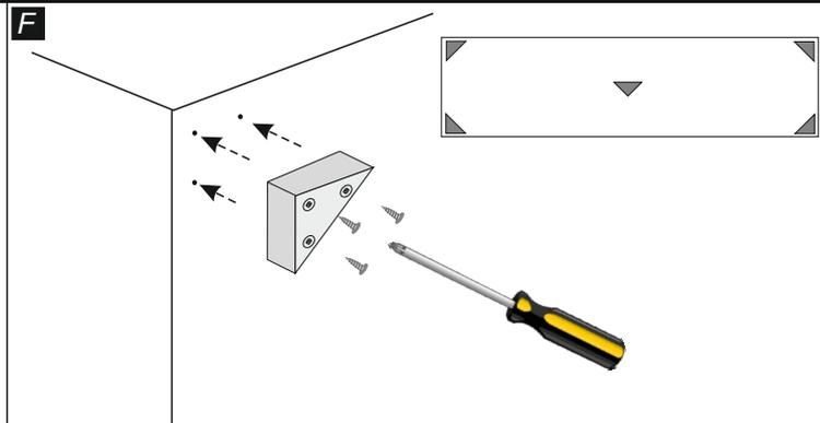
Posizionare ora il piede (fig.1) sui fori segnati sull'angolo della base come mostrato in figura. Fissare il piede con le viti 4,5x16 (fig.2) (3 viti per piede). Ripetere l'operazione sugli altri angoli con i restanti piedi. I restanti piedi vanno fissati centralmente sulla base.
