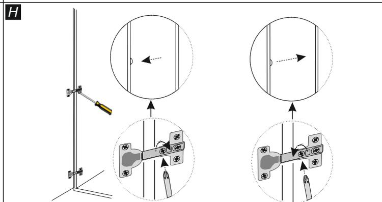
Se l'apertura/chiusura delle ante non è perfetta, è necessario agire con il cacciavite sulla vite posta al centro delle cerniere, avvitando e/o svitando leggermente. In relazione al senso di rotazione della vite sulla cerniera, l'anta si avvicina o allontana dal fianco del mobile.
