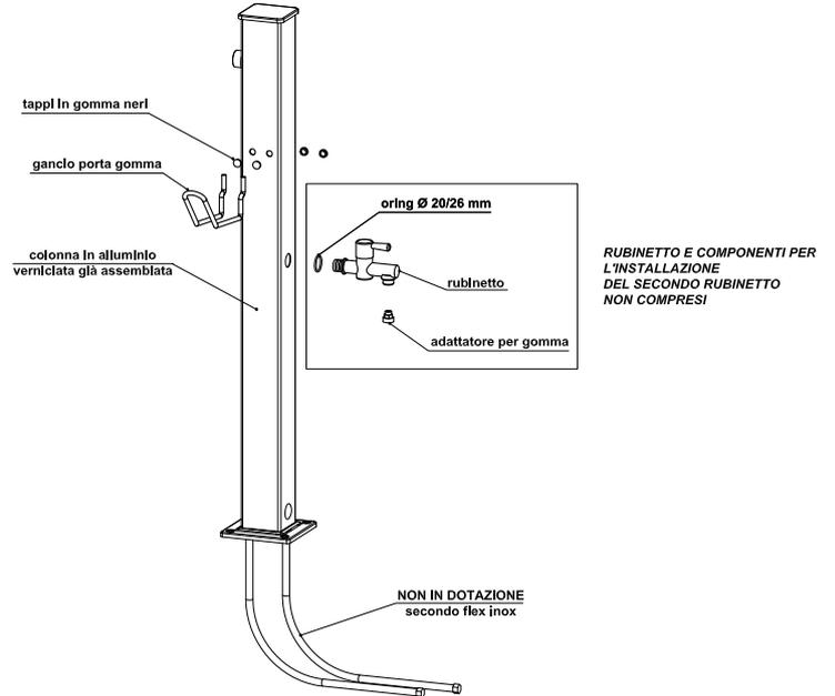
Nella fase del montaggio del secondo rubinetto non usare attrezzi di serraggio metallici (è consigliato il serraggio a mano) per evitare graffi anti-estetici o la rottura dei componenti.
