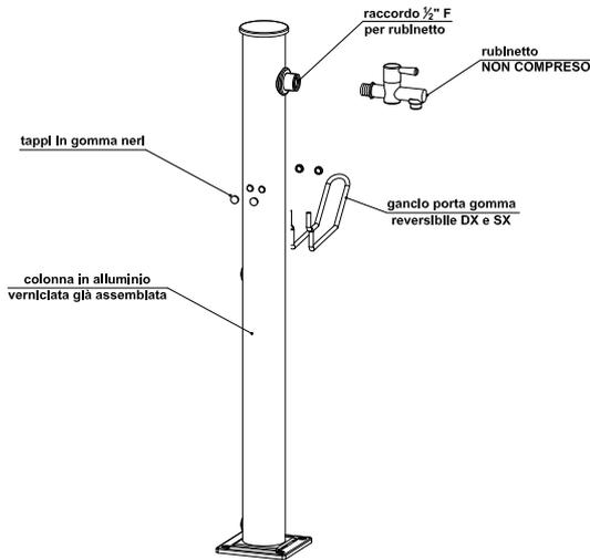
Nella fase del montaggio rubinetto non usare attrezzi di serraggio metallici (è consigliato il serraggio a mano) per evitare graffi anti-estetici o la rottura dei componenti.
