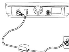
2. Collegare il ricevitore al mixer o all'amplificatore. Premete il pulsante power per accendere il ricevitore.
