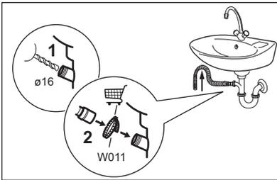
Collegare il tubo di scarico al sifone e serrarlo con una pinza. Accertarsi che il tubo di scarico formi una curva per evitare il passaggio di particelle dal lavandino all'apparecchiatura.
