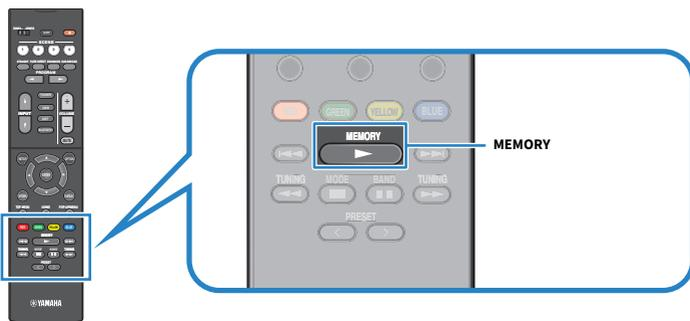
Sul display anteriore vengono visualizzati “MEMORY”, il numero del collegamento rapido con cui verrà registrato il contenuto e “Vuoto”.
