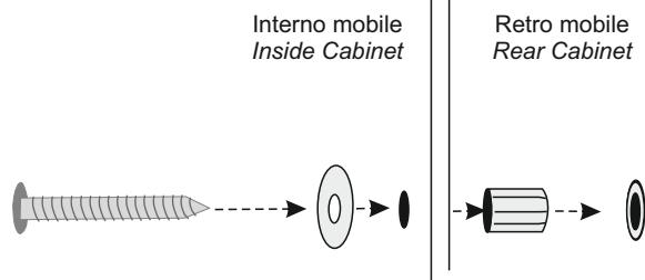
Riposizionare il mobile adiacente alla parete ed, internamente alla prima anta in alto, inserire la vite (8-d) nella rondella (8-c), e l'insieme nel foro sulla schiena, quindi sul retro, inserire la vite nel distanziale (8-b) ed inserirlo nel foro sul muro (stessa operazione con l'altro foro). Quindi fissare le viti alla parete. **Attenzione: trattenere il mobile durante questa operazione onde evitare la caduta.**
