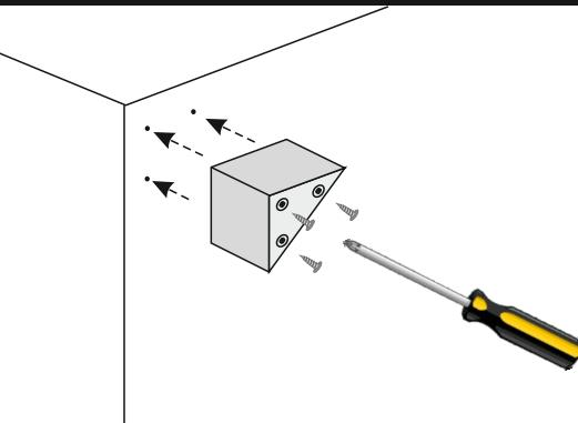
Posizionare ora il piede (fig.1) sui fori segnati sull'angolo della base come mostrato in figura. Fissare il piede con le viti 4,5x16 (fig.2) (3 viti per piede). Ripetere l'operazione sugli altri angoli con i restanti piedi.
