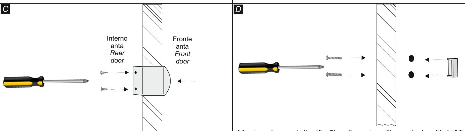
Montare la maniglia (fig.3) sull'anta utilizzando le viti 3x12 (fig.4). Tenere la maniglia in corrispondenza dei rispettivi fori sulla parte esterna dell'anta ed inserire le viti nei fori posti all'interno, quindi fissare la maniglia avvitando con il cacciavite. Ripetere l'operazione con le altre ante.
