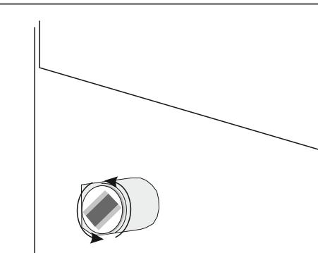
Se necessario migliorare la chiusura delle ante, agire con le dita sulle calamite di sicurezza dentro il mobile, avvitando e svitando.
