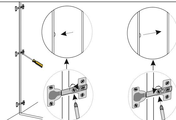
Se l'apertura/chiusura delle ante non è perfetta, è necessario agire con il cacciavite sulla vite posta al centro delle cerniere, avvitando e/o svitando leggermente. In relazione al senso di rotazione della vite sulla cerniera, l'anta si avvicina o allontana dal fianco del mobile.
