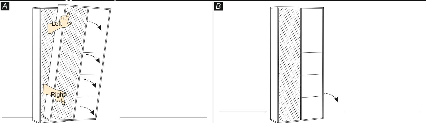
Estrarre il mobile dall'imballo e posizionarlo in piedi come mostrato in figura, quindi inclinarlo per permettere l'apertura delle ante. **ATTENZIONE: trattenere il mobile con una mano onde evitare la caduta.**
