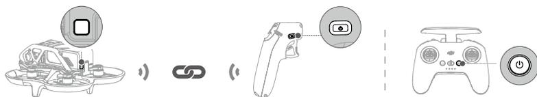
7. Una volta eseguito il collegamento, il dispositivo per il controllo remoto smette di emettere il bip ed entrambi i LED del livello della batteria si illuminano di luce fissa e visualizzano il livello della batteria.
