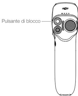
Premere due volte il pulsante di blocco per avviare i motori dell'aeromobile
