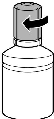
12. Chiudere saldamente il cappuccio del serbatoio dell'inchiostro.
