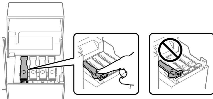
13. Chiudere saldamente il coperchio del serbatoio dell'inchiostro.
