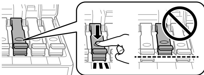
10. Chiudere saldamente il coperchio del serbatoio dell'inchiostro.
