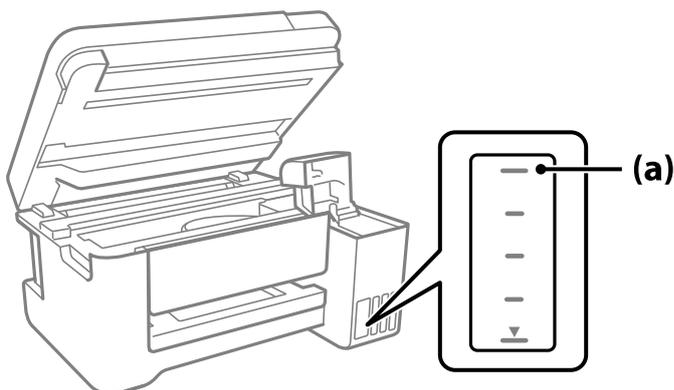
10. Allineare la parte superiore della bottiglia di inchiostro con la porta per il riempimento, quindi inserirla direttamente nella porta per versare l'inchiostro. Il flusso si interrompe automaticamente una volta raggiunta la linea superiore.
