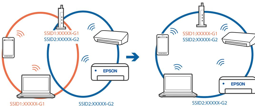
❑ Esempio di connessione a SSID con un diverso intervallo di frequenza
