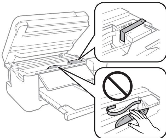
9. Assicurarsi di installare saldamente il cappuccio sul serbatoio di inchiostro.
