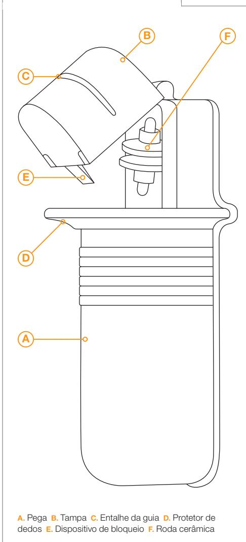
A. Pega B. Tampa C. Entalhe da guia D. Protetor de dedos E. Dispositivo de bloqueio F. Roda cerâmica
