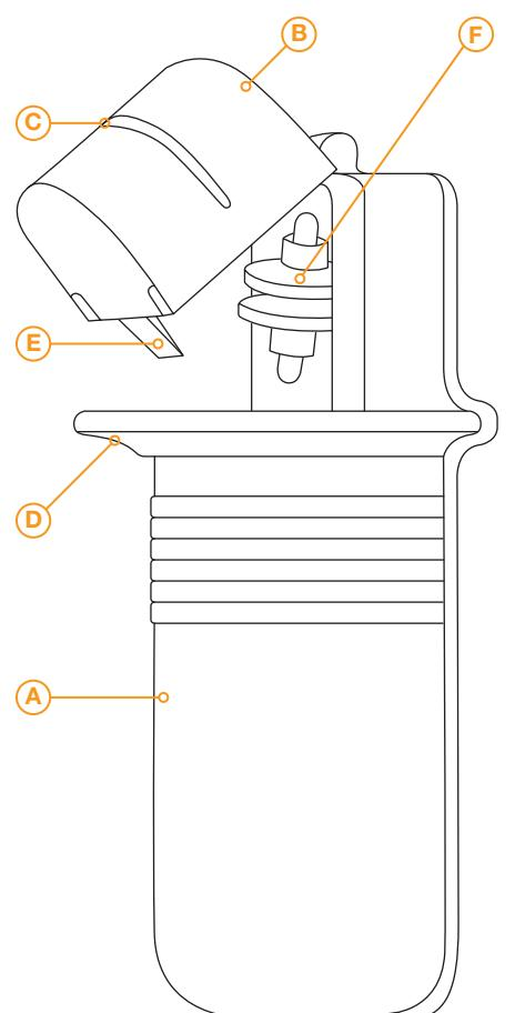
A. Rukoväť B. Kryt C. Vodiaca drážka D. Chránič prstov E. Zaistenovací kryt F. Keramický kotúčik
