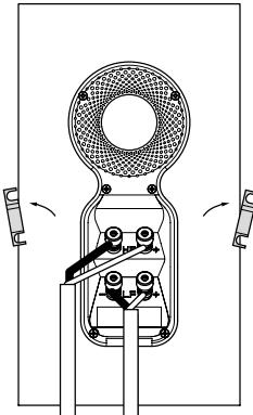
스피커의 플러스 단자(+ 및 적색으로 표시)와 앰프의 플러스 출력 단자가, 스피커의マイ너스 단자(- 및 흑색으로 표시)와 앰프의マイ너스 출력 단자가 올바르게 연결되었는지 확인하십시오. 연결이 올바르지 않을 경우 사운드 이미지가 흐려지고 저역이 손실될 수 있습니다.
