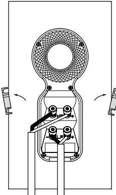
Branchez la prise « positif » de l'enceinte (prise de couleur rouge, avec le repère « + ») sur la prise de sortie enceinte « positif » de l'amplificateur, et branchez la prise « négatif » (prise de couleur noire, avec le repère « - ») sur la prise « négatif » de l'amplificateur. Le non-respect de cette polarité plus/moins entraîne une image stéréophonique dégradée et une perte dans le grave.
