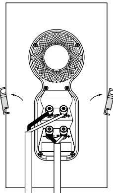
Bizonyosodjon meg arról, hogy a hangsugárzó pozitív terminálja (+ jellet jelölt és piros színű) az erősítő pozitív kimenetéhez csatlakozik, valamint a hangsugárzó negatív terminálja (- jellet jelölt és fekete színű) az erősítő negatív pontjához csatlakozik. Fordított csatlakozás esetén a hangkép zavaros és a mélyhang hiányos lesz. A zörgések elkerülésének érdekében minden szorosan húzza meg a csatlakozókat.
