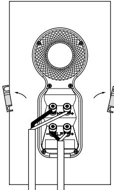
Upewnij się, że gniazda połączeniowe z czerwonym obramowaniem zostały połączone z gniazdami o dodatniej polaryzacji na wzmacniaczu a gniazda z czarnym obramowaniem z gniazdami o ujemnej polaryzacji na wzmacniaczu. Nieprawidłowe połączenie będzie skutkowało pogorszeniem jakości dźwięku i utratą niskich tonów.
