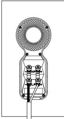
Wszystkie połączenia powinny być dokonywane przy wyłączonych urządzeniach audio.
