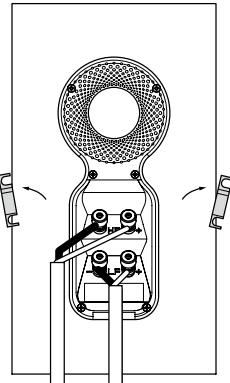
Подсоедините плюсовый разъем колонки (со знаком + и окрашенный в красный) к плюсовому выходу усилителя, а минусовой (со знаком – и окрашенный в черный) – к минусовому на усилителе. Неверное подключение приведет к искажению звукового образа и утере басов.
