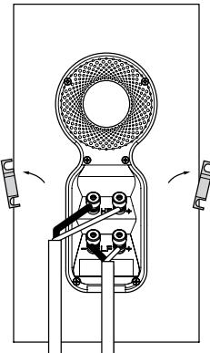
Certifique-se de que os terminais positivos da coluna (marcados com o sinal + e de cor vermelha) estão ligados ao terminal de saída positiva do amplificador e que os terminais negativos da coluna (marcados com o sinal - e de cor preta) estão ligados ao terminal de saída negativa do amplificador. Uma ligação incorrecta pode resultar numa imagem fraca e na perda de sons graves.
