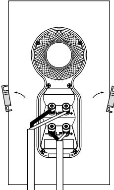
Asegúrese de que los terminales positivos de la caja acústica (marcados como + y de color rojo) son conectados al terminal de salida positivo del amplificador y que los terminales negativos de la caja acústica (marcados como - y de color negro) son conectados al terminal de salida negativo del amplificador. Una conexión incorrecta podría tener como resultado una imagen sonora pobre y una pérdida de graves.
