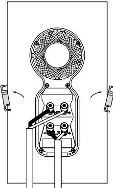
Stellen Sie sicher, dass die positiven (roten und mit + gekennzeichneten) Anschlussklemmen am Lautsprecher mit dem positiven Ausgang am Verstärker und die negativen (schwarzen und mit - gekennzeichneten) Anschlussklemmen mit dem negativen Ausgang am Verstärker verbunden werden. Ein nicht korrektes Anschließen der Kabel kann zu einer Verschlechterung des Klangbildes und zu Bassverlusten führen.
