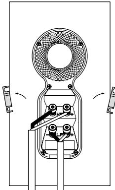
Dbejte, aby kladný kontakt reprosoustavy (označený červeně a znaménkem +) byl připojen ke kladnému kontaktu zosilovače a záporný kontakt (označený černě a znaménkem -) k zápornému. Nesprávné zapojení může mít za následek špatný stereofonní obraz a úbytek basů. Matice terminálů vždy pevně dotáhněte, aby nedocházelo k rezonancím.
