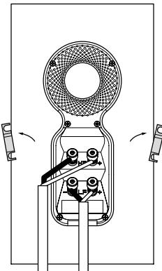
Hoparlördeki pozitif terminalerin (+ işaretli kırmızı renkli) amplifikatördeki pozitif çıkış terminalerine ve negatif terminalerin (- işaretli siyah renkli) amplifikatördeki negatif çıkış terminalerine bağlı olduğundan emin olun. Yanlış bağlantı durumu, kötü imgelemeye ve bas seslerde kayıp yaşanmasına yol açabilir.
