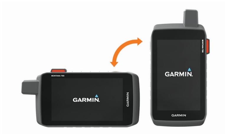
**NOTA:** quando si utilizzano le funzioni inReach del dispositivo Montana 700i/750i, è necessario utilizzare il dispositivo in modalità verticale (ritratto), con l'antenna puntata verso il cielo.
