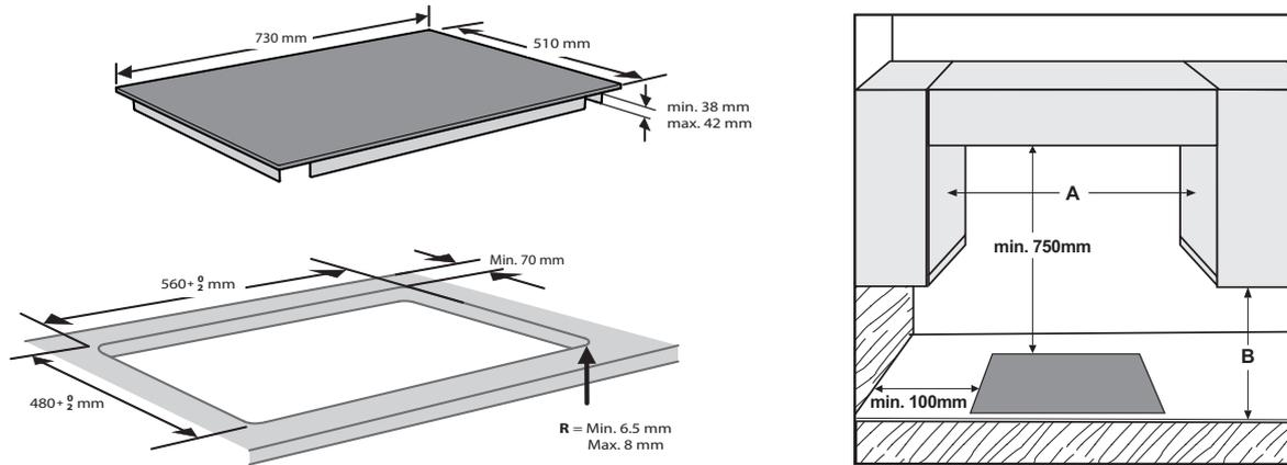
**NOTA:** se la distanza "A" tra i pensili è compresa tra 600 mm e 730 mm, l'altezza "B" deve essere minimo 530 mm. Se la distanza "A" tra i pensili è maggiore della larghezza del piano di cottura, l'altezza "B" deve essere minimo 400 mm. Qualora venga installata una cappa sopra il piano di cottura, fare riferimento alle istruzioni di montaggio della cappa per la distanza da rispettare.
