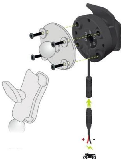
**Importante:** il contatto rosso POS (+) deve essere collegato al telaio dei cavi della moto in un punto tra il motore e l'alimentazione a batteria da +12V. Il contatto nero NEG (-) deve essere collegato al telaio dei cavi della moto in un punto tra il motore e l'alimentazione a batteria -(GND). Collegalo a un punto da 12V che possa essere disattivato dal motore, ad esempio al circuito luci.
