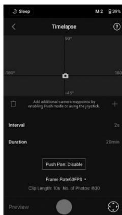
In Timelapse, DJI RS 2 attiva la fotocamera per acquisire fermi immagine secondo l'intervallo di tempo specificato e si arresta automaticamente al termine. È possibile specificare la durata del Timelapse e la frequenza dei fotogrammi in modo che DJI RS 2 sia in grado di calcolare il numero esatto di immagini richieste.
