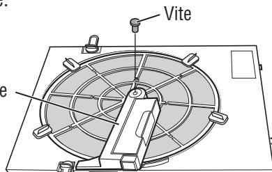
Se l'unità contenitore polvere non è fissata adeguatamente, non è possibile fissare il pannello di aspirazione. Inoltre, è possibile udire un suono (rumoroso) anomalo.
