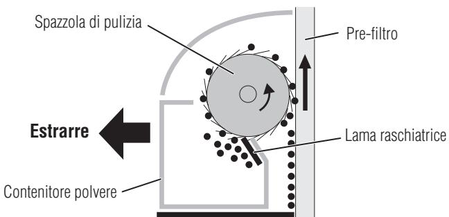
La polvere accumulata sulla lama raschiatrice può accumularsi in una forma allungata che non consente il passaggio nel contenitore della polvere. Se la polvere nel pre-filtro viene rimossa, il meccanismo di pulizia funziona adeguatamente.
