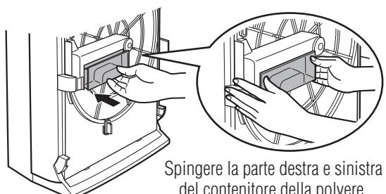
Se non propriamente fissato, la rimozione della polvere diventa difficile.
