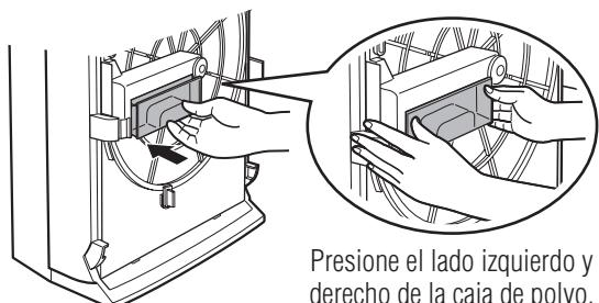
Si no se coloca correctamente, la eliminación del polvo puede resultar difícil.
