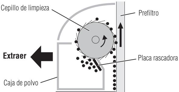
El polvo acumulado en la placa rascadora puede juntarse en una larga forma de cinturón que no cae en la caja de polvo. Si se elimina la suciedad del prefiltro, el mecanismo de limpieza funciona correctamente.
