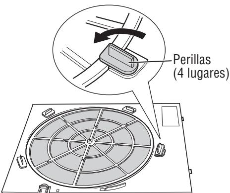
③ Inserte la pestaña (1 lugar) en la unidad de caja de polvo en el orificio de la unidad de prefiltrado y, a continuación, deslice la unidad de caja de polvo.
