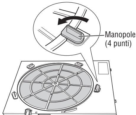
③ Inserire la linguetta (1 posizione) sull'unità contenitore polvere all'interno del foro nell'unità pre-filtro, quindi far scivolare l'unità contenitore polvere.
