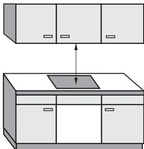
Tra il piano cottura e una cappa aspirante posta al di sopra dell'apparecchio è necessario mantenere la distanza di sicurezza indicata dalla casa produttrice.
