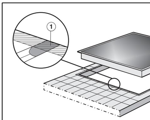
Le fessure ① e l'area tratteggiata sotto la superficie d'appoggio del piano cottura devono essere lisce e perfettamente in piano affinché il piano poggi uniformemente e la guarnizione applicata sotto il bordo della parte superiore dell'apparecchio possa garantire una tenuta sufficiente verso il piano di lavoro.
