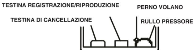
La testina di registrazione e quella di cancellazione e la superficie del rullo pressore sono delicati e non devono essere toccati con oggetti metallici come i cacciaviti. E' meglio pulirli premendo il tasto PLAY. Accertarsi di premere il tasto STOP una volta terminata la pulizia del meccanismo.
