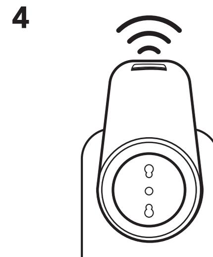
4 Premere il pulsante on/off per più di 5 secondi fino a quando l'indicatore WiFi non inizia a lampeggiare rapidamente. Lo switch Wi-Fi è ora pronto per la sincronizzazione.
