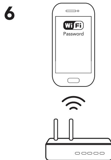
6 Assicurarsi che il proprio smartphone e switch Wi-Fi siano nella stessa rete Wi-Fi. Il processo di collegamento richiede circa 30-120 secondi, a seconda delle condizioni della propria rete e dalla lunghezza della password Wi-Fi.
